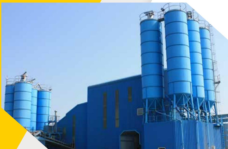
PRODUZIONE 80/120 - 100/120 M<sup>3</sup>/H ALIMENTAZIONE TRAMITE NASTRO DI CARICO
